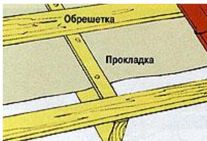
**Внимание!!!** Сначала укладывается гидроизоляционный материал, а только затем монтируется обрешетка.
