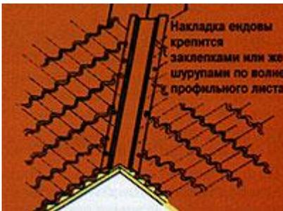
Для внутренних стыков на крышах, применяется стандартная планка для разжелобки LSJ. Нахлест планок для разжелобки должен составлять не менее 150 мм. а геометизация шва выполняется уплотнительной массой. На внутренний стык можно смонтировать накладку ендовы LSPL. Ее крепят без уплотнителей, заклепками или шурупами по верху волны профиля с расстоянием в 300 - 500 мм.
